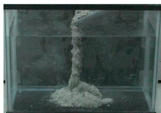
水中不分離性重量コンクリート
