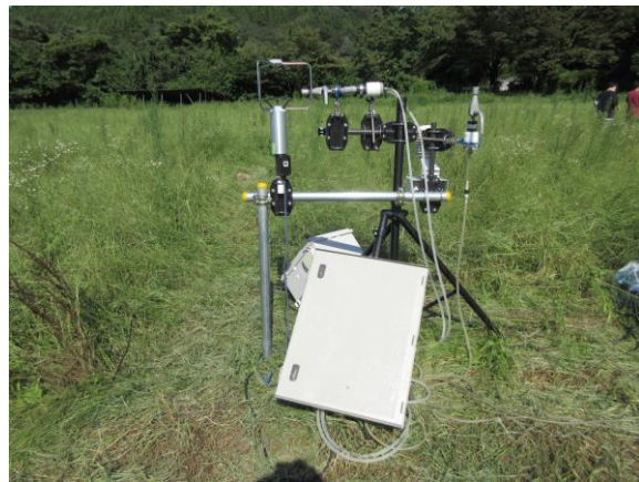
図 1. PM_{2.5} サイクロンフィルターパックを用いた REA 法および参照法測定システム。
