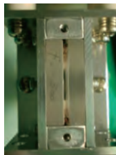
図 2 ガラスイオン流路の正面写真
