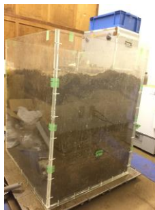
図-2 埋設管を設置した土槽
