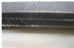
写真① 積層ゴム
