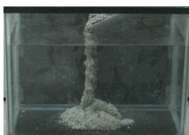
水中不分離性 重量コンクリート
