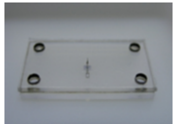
図2 採血・重力利用血漿分離デバイス
