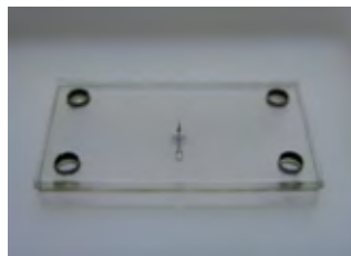
図2 採血&重力利用血漿分離デバイス
