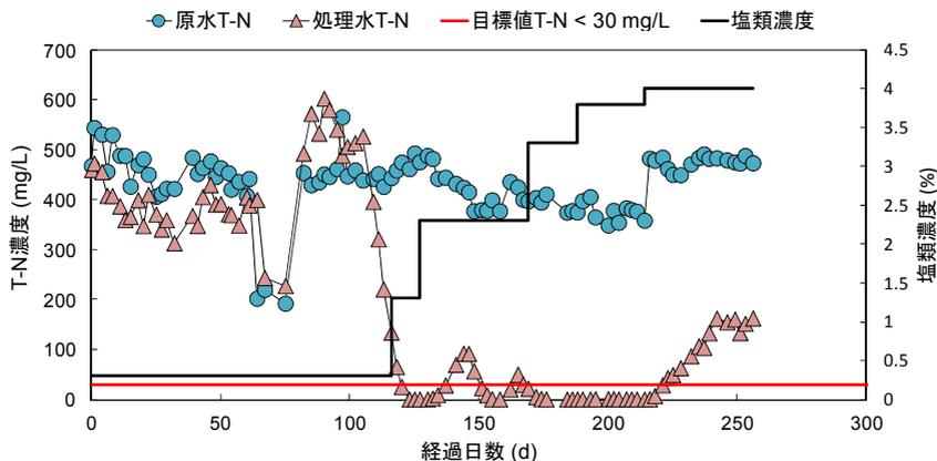
図1 連続処理運転での水質変化
