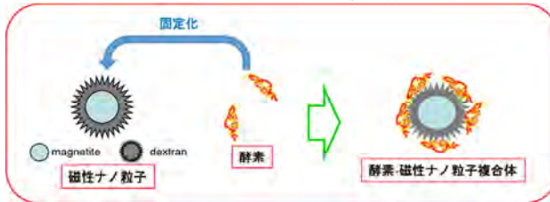
図 1. 酵素-磁性ナノ粒子複合体の作製
