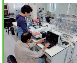
ゼータ電位・粒径測定装置
