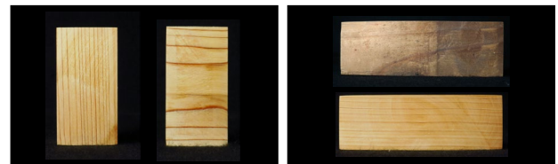
写真1 縦・横圧縮試験体 写真2 部分圧縮試験体
