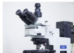
酵母細胞の評価に使用する蛍光顕微鏡
