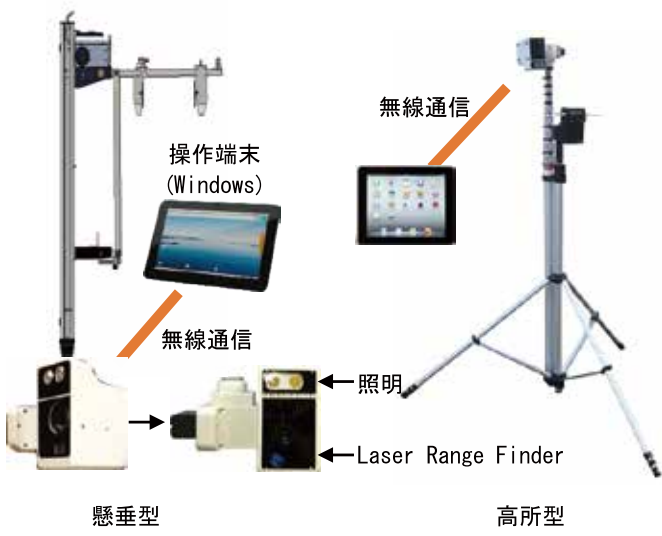
橋梁点検ロボットカメラ
