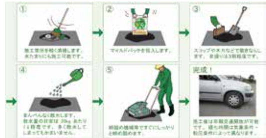
■ 「マイルドパッチ」施工手順
