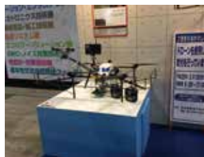
当社開発「吹付けドローン」
