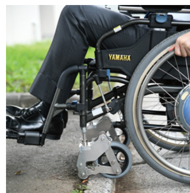
4cmの段差を乗り越える様子。4cmという高さは、一般的なキャスター(6インチ)ではほぼ乗り越え不可能な高さ。
