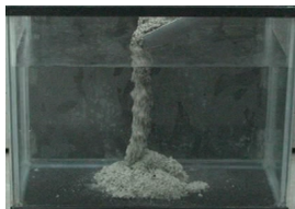
水中不分離性 重量コンクリート
